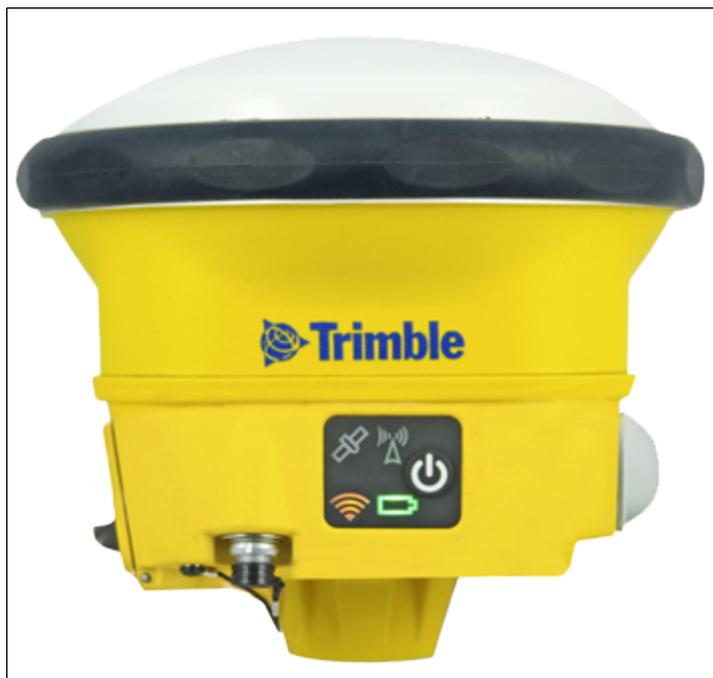
Смарт-антенну SPS985 можно использовать в составе GNSS-системы для RTK-измерений в случае применения ПО Trimble SCS900 Site Controller. При наличии соответствующей опции приемник может записывать GPS-данные в дополнительную внутреннюю память приемника и передавать эти данные на компьютер посредством последовательного интерфейса.
