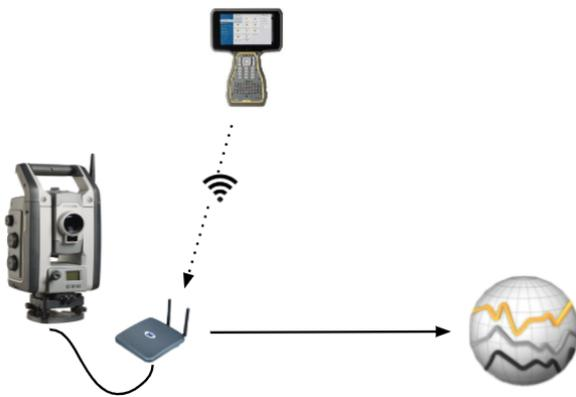
2. Settop 소프트웨어를 통해 모니터링 M1 측량기 제어를 해제합니다. 이렇게 하려면 ≡을 누르고 **데이터 교환 / Settop M1 / 측량기 제어 해제**를 선택합니다. Settop M1 사용자 이름과 비밀번호를 입력하고 **해제**를 누릅니다.
