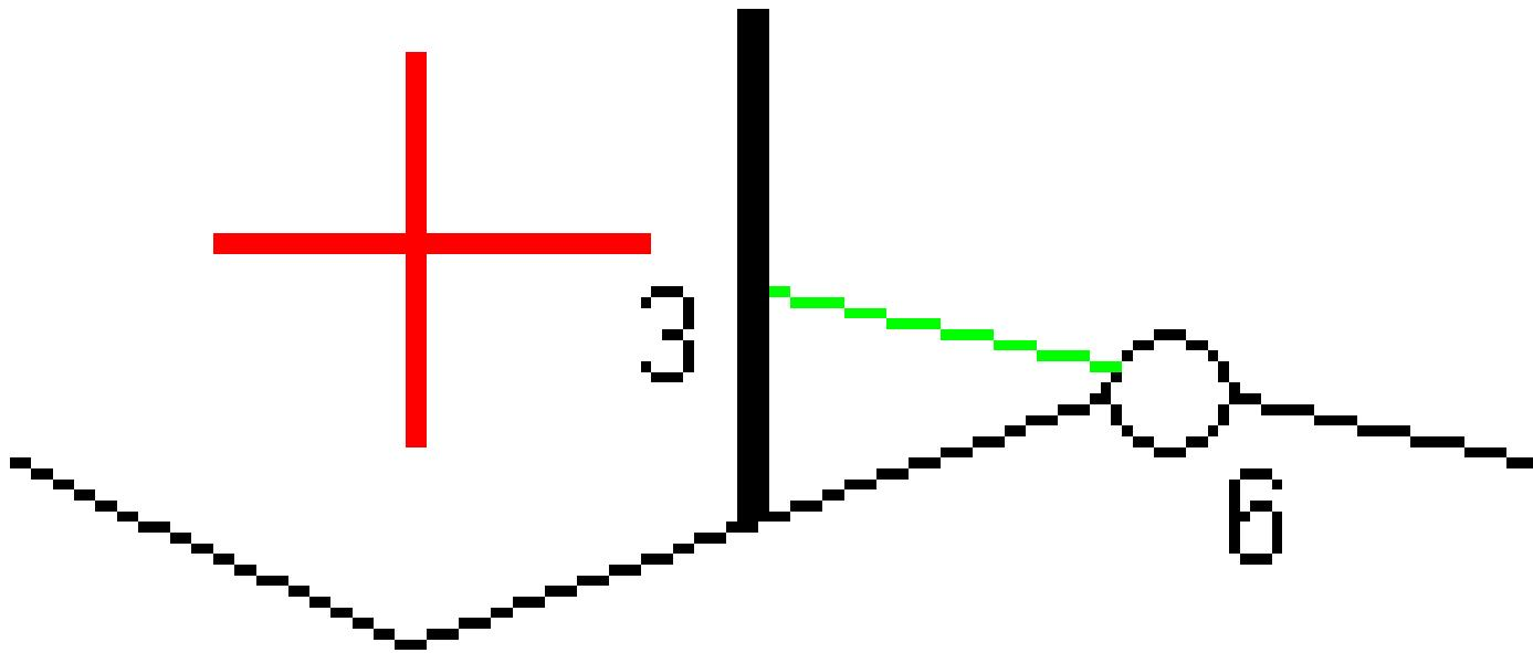
**ПРИМЕЧАНИЕ** – Для точек с нулевым сдвигом вы не можете применить строительный сдвиг в плане со значением уклона предыдущей линии.
