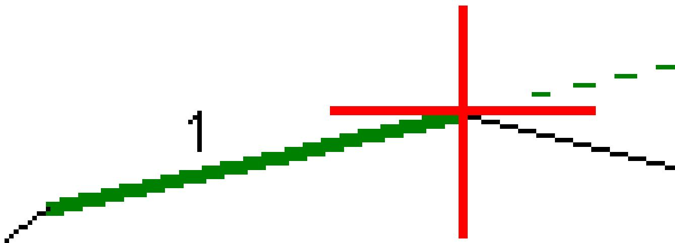
**ПРИМЕЧАНИЕ** – Нельзя задать поперечный уклон, выбрав линию, определяющую боковой откос.
