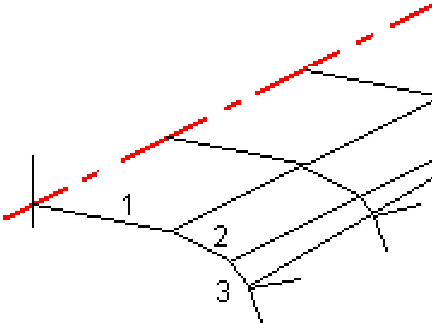
Лучший способ управления процессом интерполяции для максимального соответствия проекту трассы - это добавление секций с нулевым сдвигом.
