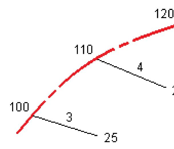
但是,如果 3D 路线的偏转角比相关 6D 路线的偏转角大 30 分钟,那么,相关 6D 路线的几何将会被 忽略,并且,坐标将由线性插值计算。当在沿着 3D 路线的方向上有一些要素(例如:滑巷、巴士港站, 等等)发生突变时,这可以避免意外。
