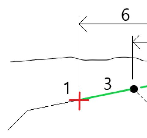
确认已放样变化量屏幕中报告的次要道路放样细节包括:到道路的垂直距离(4)、水平施工偏移 量(计算的)(5)和到定线的距离(6)。
