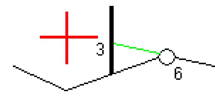
注意 - 对于零偏移的点,不能在上一条线的坡度值上应用施工水平偏移量。
