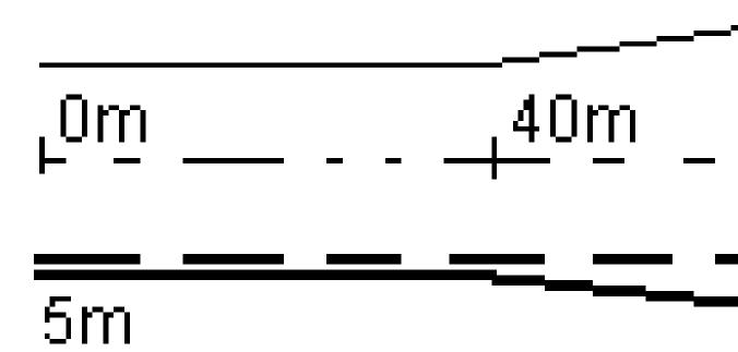
如果您选择一个具有5米偏移量的偏移/路线,偏移量将按照实线为后续桩号更新。在此例中,偏移量将在40米和80米的桩号间从5米改变到8米,然后对后续桩号保持在8米。
