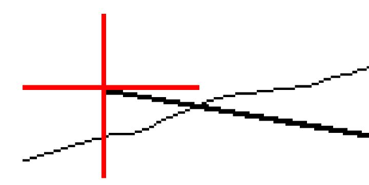
平面视图将显示已计算的交点。已计算的边坡值(兰色)和设计的边坡值出现在屏幕顶部。
