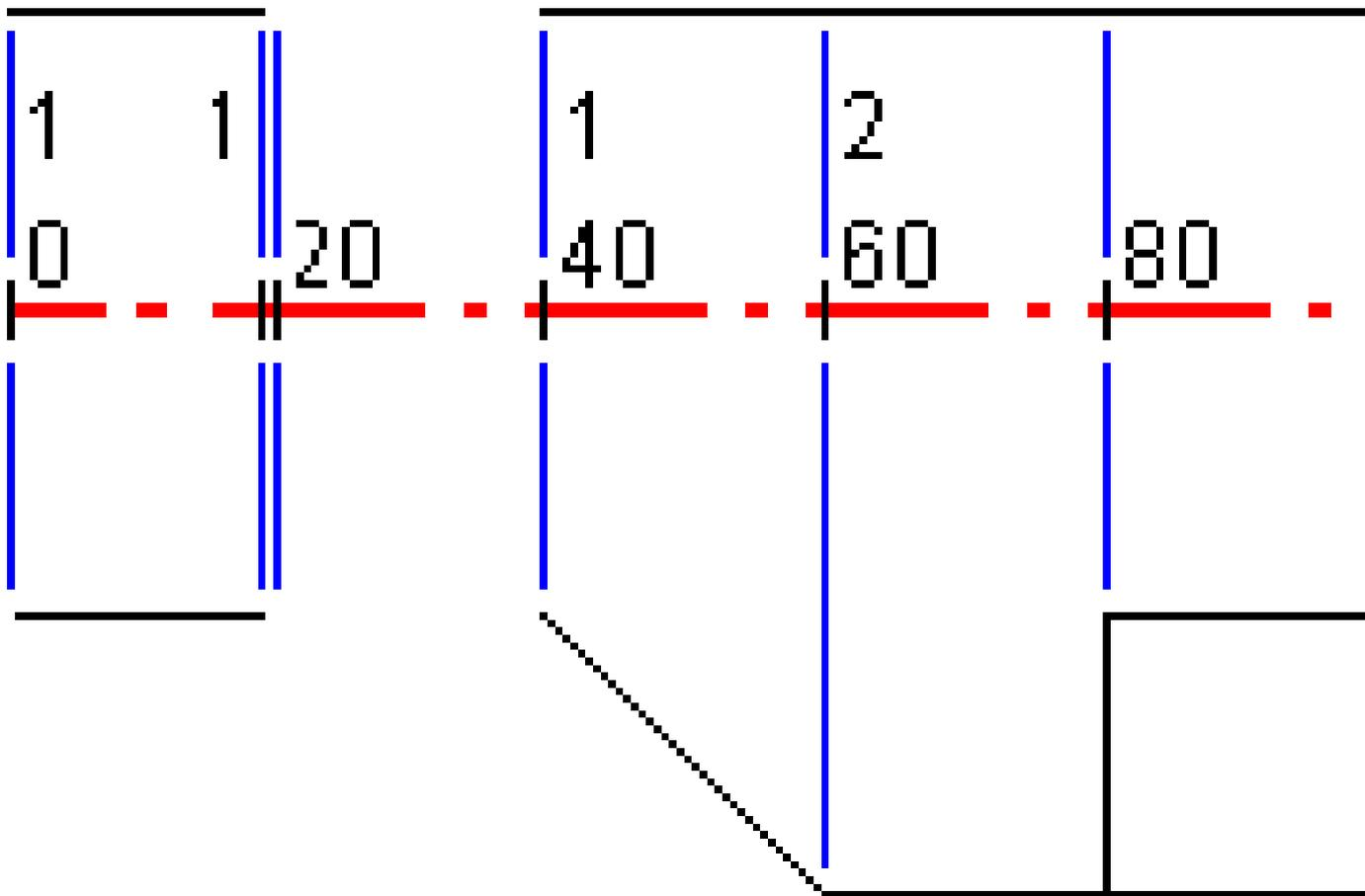
在下图中也可看到2个模板, 模板1(图的左侧)有2个表面, 模板2有3个表面:
