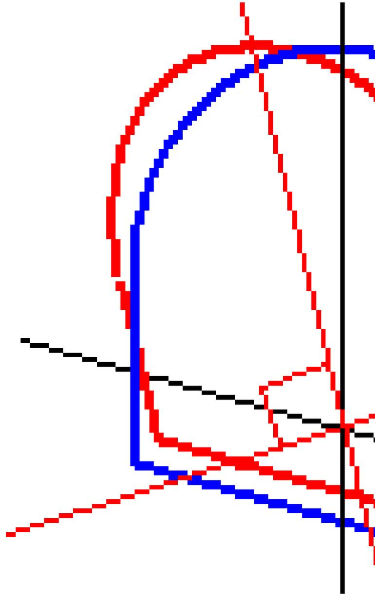
使用**点管理器**或**检查任务**可以按照模板垂直于定线应用的方式计算出点相对于隧道的测站和偏移量。如果模板正交于隧道位置应用，测站和偏移量将会不同。
