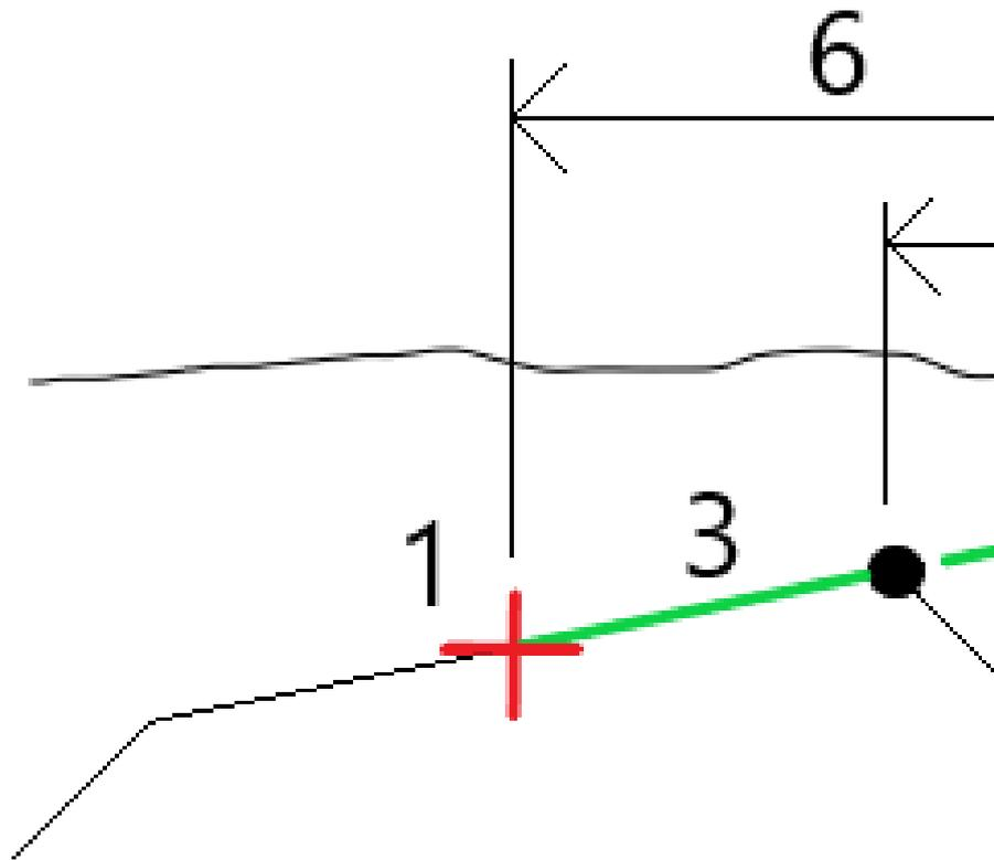
Absteckdetails für die Sekundärtrasse, die im Bildschirm **Abgesteckte Differenzen bestätigen** ausgegeben werden, enthalten die Werte für „dH zu Trasse“ **(4)**, „horizontale Baufreiheit (berechnet)“ **(5)** und „Strecke zum Kurvenband“ **(6)**.
