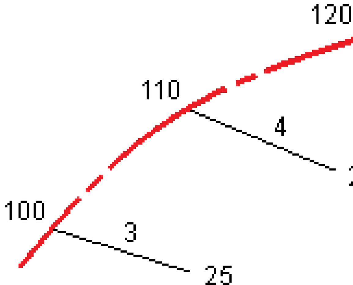
Wenn jedoch die Richtungsorientierung des 3D-Linienzugs im Vergleich zur Richtungsorientierung des 6D-Linienzugs mehr als 30 Minuten beträgt, wird die Geometrie des zugeordneten 6D-Linienzugs ignoriert, und stattdessen werden die Koordinaten linear interpoliert. Auf diese Weise soll ein unerwartetes Verhalten ausgeschlossen werden, wenn es eine akute Richtungsänderung im 3D-Linienzug für Merkmale wie Umgehungsspuren, Busbuchten usw. gibt.
