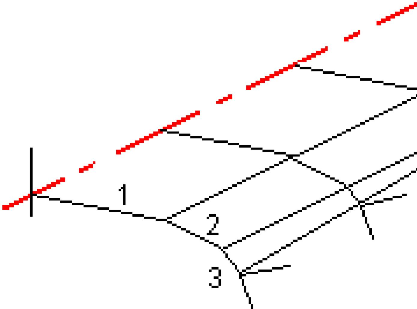
Al añadir cadenas con una distancia al eje definida de cero, podrá controlar aún más el proceso de interpolación para representar de mejor modo el diseño vial.
