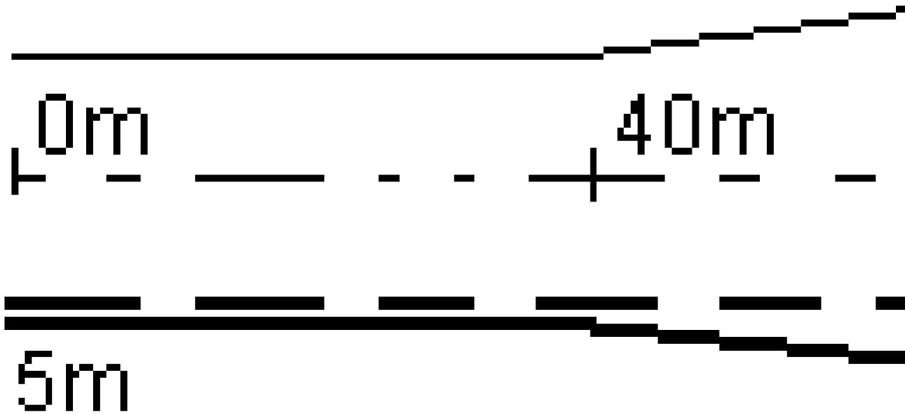
Si selecciona una distancia al eje/cadena que tiene un valor de distancia al eje de 5m, el valor de distancia al eje se actualizará para seguir la línea continua en las estaciones subsiguientes. En este ejemplo, la distancia al eje cambia de 5m a 8m entre las estaciones 40m y 100m y luego se mantiene en 8m para las estaciones siguientes.
