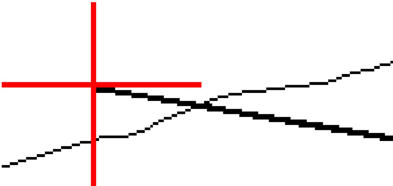
La vista del plano muestra la posición de intersección calculada. El valor de pendiente calculado (en azul) y el valor de la pendiente de diseño aparecen en la parte superior de la pantalla.
