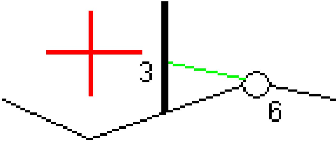
**NOTA** - Para puntos con distancia al eje de cero, no se podrán aplicar distancias al eje de construcción horizontales en un valor de pendiente de la línea anterior.
