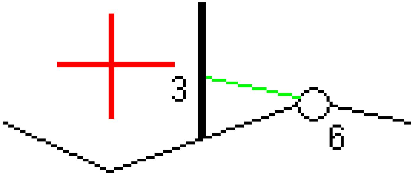
**NOTA** - Per i punti con offset zero, non è possibile applicare gli offset costruzione orizzontale al valore pendenza della linea precedente.
