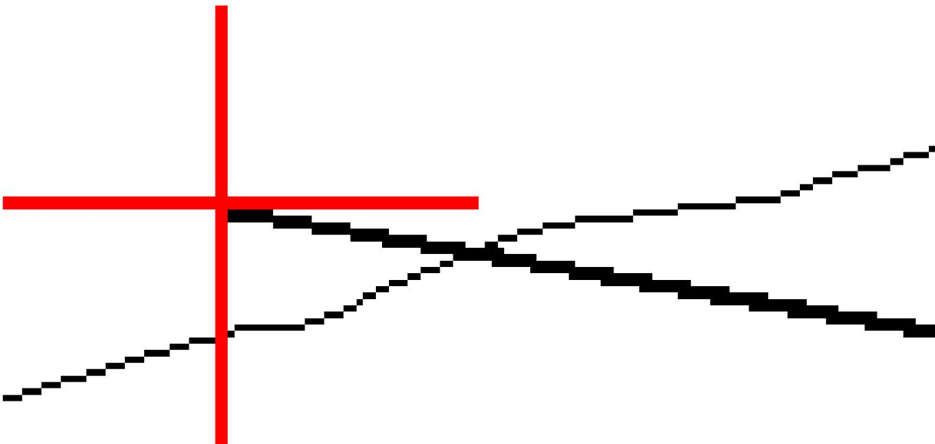
La vista piano mostra la posizione di incontro calcolata. Il valore di pendenza calcolato (in blu) e il valore di pendenza del progetto vengono visualizzati nella parte superiore dello schermo.
