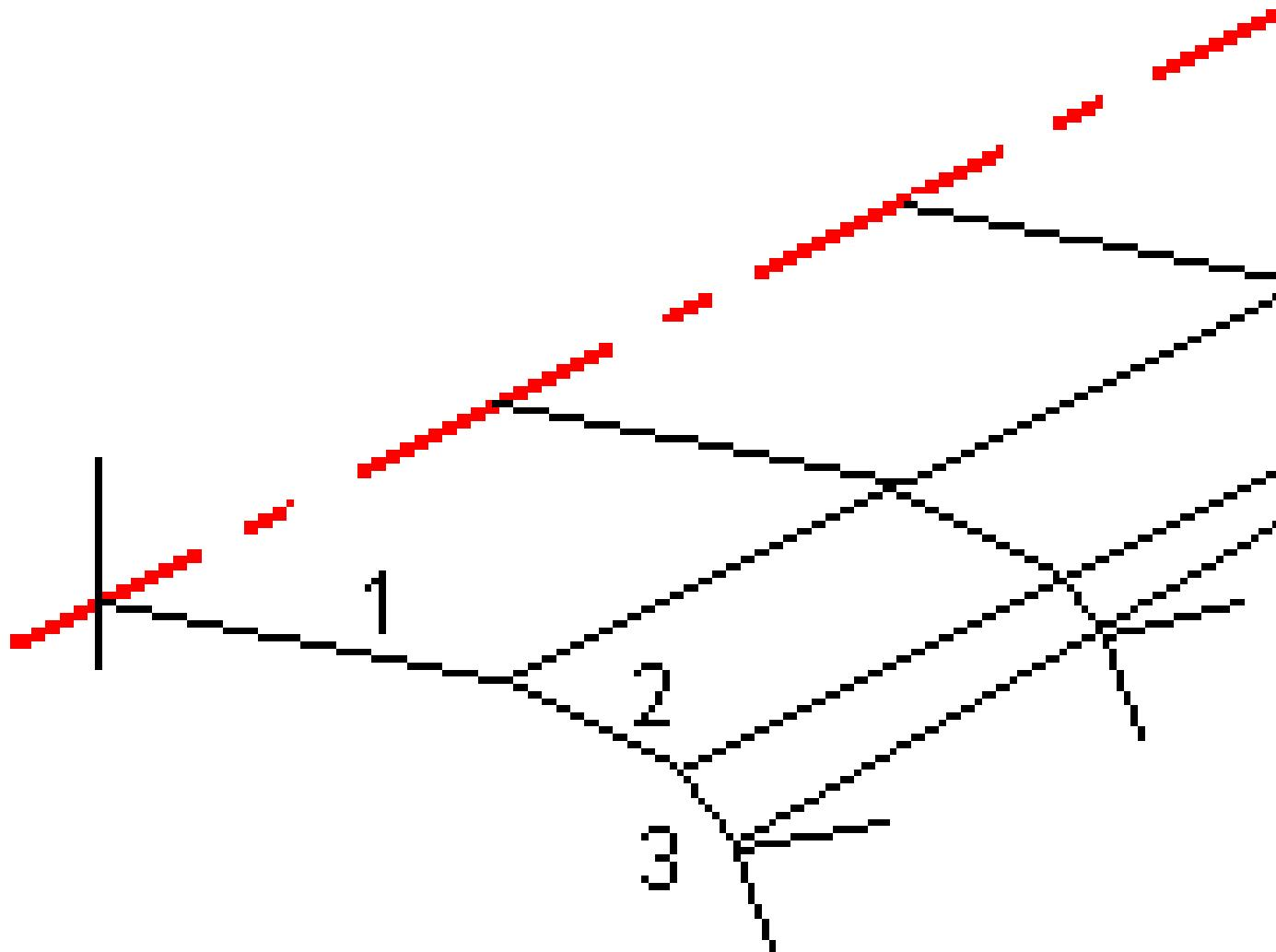
ゼロオフセットで定義されたストリングを加えることで、補間プロセスをさらにコントロールし、道路設計の描写の質を最大限にまで高めることができます。
