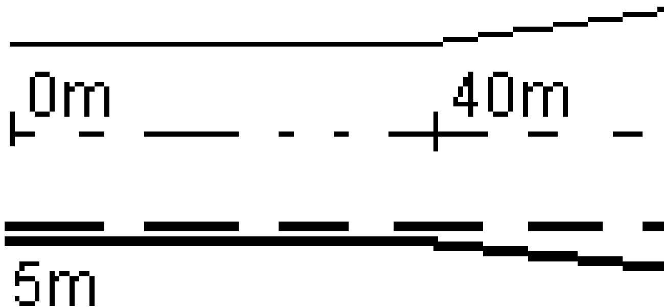
5 mのオフセット値を有するオフセット/ストリングを選択すると、オフセット値は、その後のステーションで実線に沿った形でアップデートします。この例では、オフセットは、40 mと100 mのステーションの間で5 mから8 mに変化した後、その後のステーションでは8 mを維持しています。
