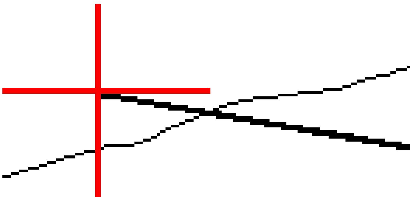
平面図表示は計算されたキャッチポイントの位置を表示します。計算された勾配値(青色)と設計勾配値はスクリーンの最上部に表示されます。
