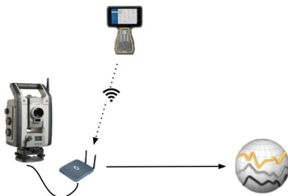
2. Desative o controle de instrumento do Settop M1 através do software Monitorando. Para fazer isso, pressione **☰** e selecione **Troca de dados / Settop M1 / Desativar controle de instrumento**. Insira seu nome de usuário e senha do Settop M1 e pressione **Desativar**.
