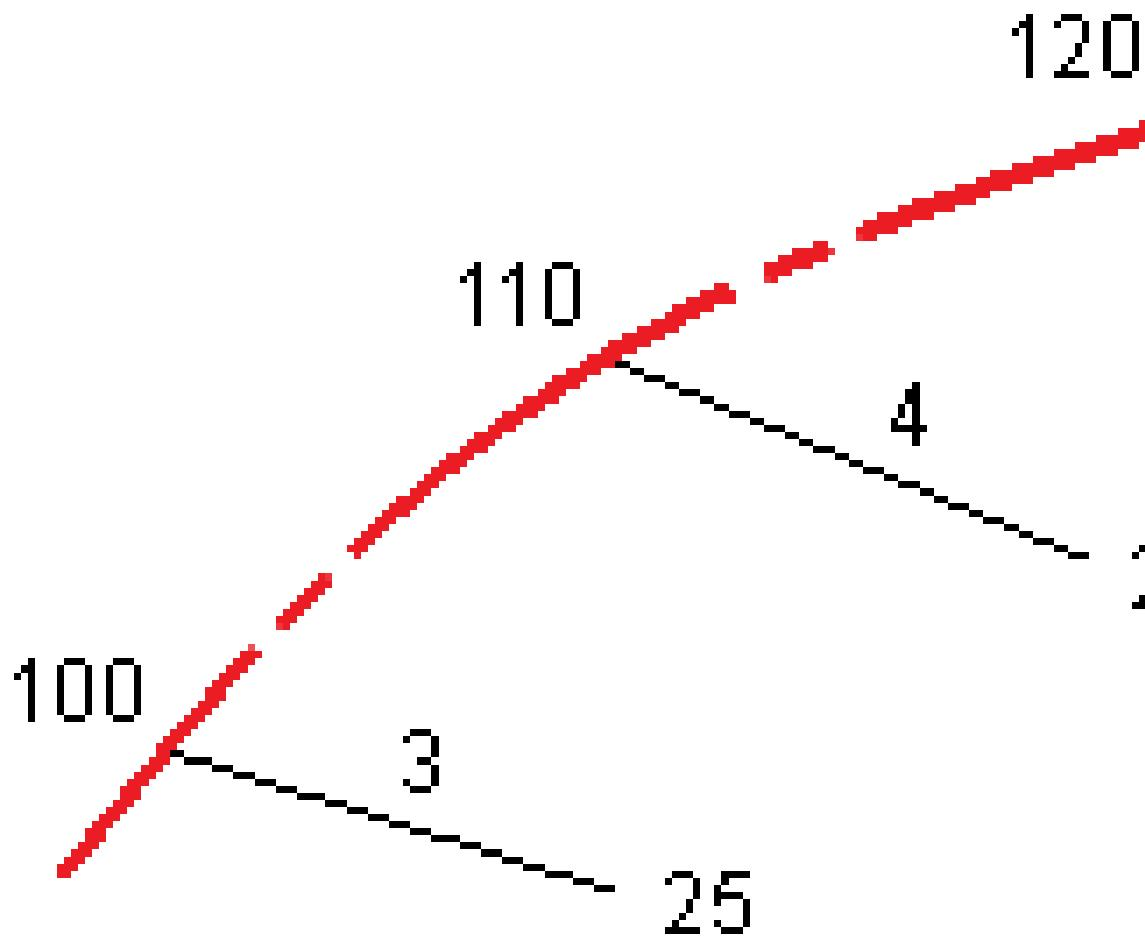
但是，如果 3D 路线的偏转角比相关 6D 路线的偏转角大 30 分钟，那么，相关 6D 路线的几何将会被忽略，并且，坐标将由线性插值计算。当在沿着 3D 路线的方向上有一些要素(例如：滑巷、巴士港站，等等)发生突变时，这可以避免意外。
