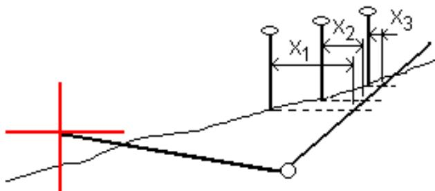
平面视图将显示已计算的交点。已计算的边坡值(兰色)和设计的边坡值出现在屏幕顶部。
