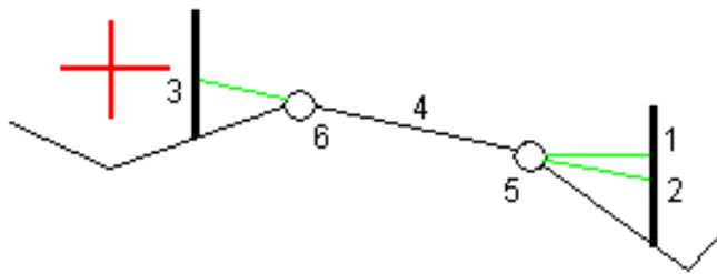
**注意 -**对于零偏移的点，不能在上一条线的坡度值上应用施工水平偏移量。
