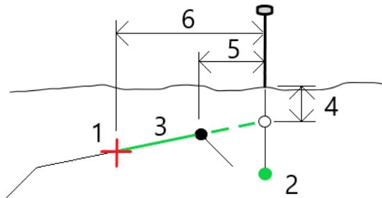
确认已放样变化量屏幕中报告的次要道路放样细节包括：到道路的垂直距离(4)、水平施工偏移量(计算的)(5)和到定线的距离(6)。
