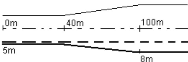
如果您选择一个具有5米偏移量的偏移/路线，偏移量将按照实线为后续桩号更新。在此例中，偏移量将在40米和80米的桩号间从5米改变到8米，然后对后续桩号保持在8米。
