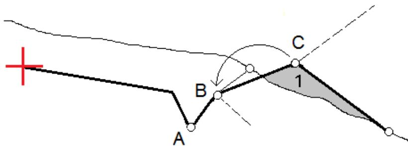
将路线**B**选择为节点路线，可以通过保留设计斜坡值或键入另一个值来定义挖坡。作为替换方式，可以通过选择以下一项来定义挖坡：
